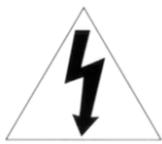
Le symbole d'un éclair dans un triangle doit mettre en garde l'utilisateur sur la présence d'un fort courant non isolé à l'intérieur de l'appareil et d'une intensité suffisante pour constituer un risque d'électrocution .
