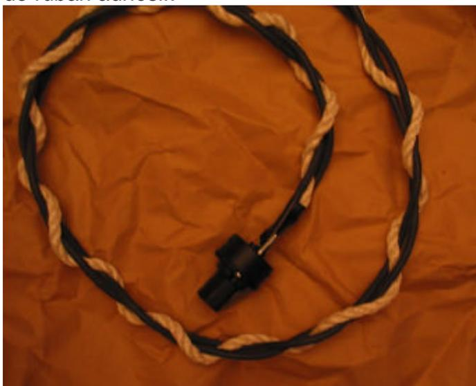
Connecter 2 fils ( ref Radiospares 222-7358 cuivre isolé caoutchouc de 2.5mm<sup>2</sup> ) à la masse :
